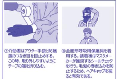
①介助者はアウター手袋と防護服のつなぎ目を自止める。この時、取り外ししやすいようにテープの端を折り込む。
